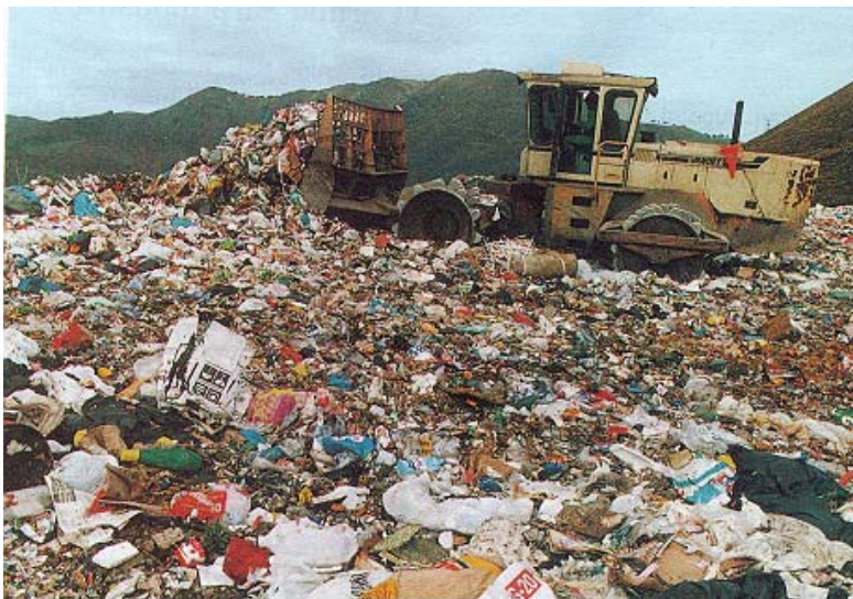
Figura 7.10 - Equipamento comum para espalhamento e compactação de resíduos
